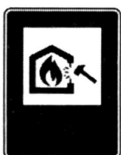
Место вскрытия конструкции
