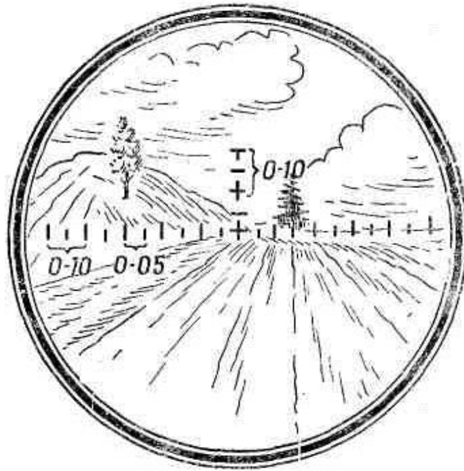
Рис.1. Измерение углов с помощью бинокля
