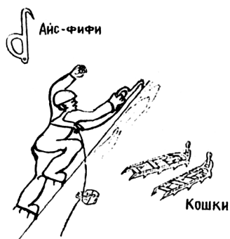
Рис. 4.10. Техника лазания по деревянным конструкциям
