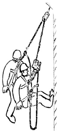
Рис. 4.24. Схема спуска пострадавшего одним спасателем
