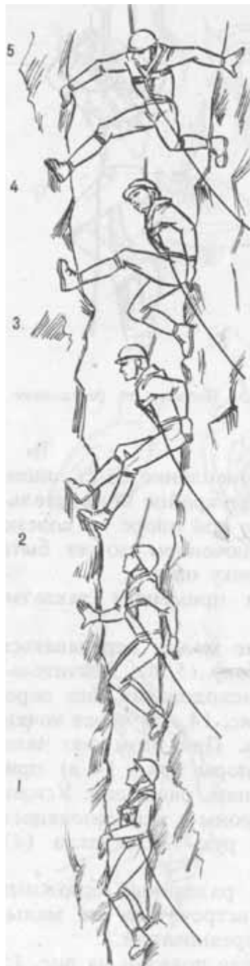
Рис. 17. Передвижение по камину: 1 - узкому; 2 - среднему; 3,4 и 5 - широкому
