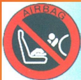
В автомобиле с подушкой безопасности для переднего пассажира, на видном месте наклеивают метку, запрещающую закреплять на этом сиденье детское кресло, обращенное назад. Иногда дополнительно на торце панели приборов или на передней стойке располагают кнопку отключения этой подушки.
