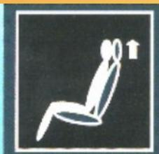
**Автоматическая система защиты при опрокидывании** разворачивается в случае опрокидывания ТС. Она, как правило, установлена в спинках кресел и в панели за задним сидением. Места расположения маркируются надписью R.O.P.S. или специальным значком..
