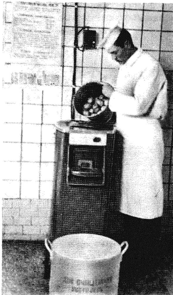
Рис. 13. Очистка картофеля в механической картофелечистке
