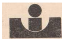
Рис. 1. Схема прицеливания при открытом прицеле
