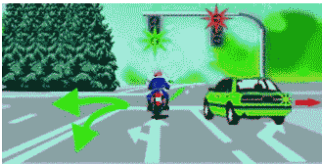
"Рисунок 6. Регулирование движения по каждой полосе отдельным светофором с сигналами направлений движения"
