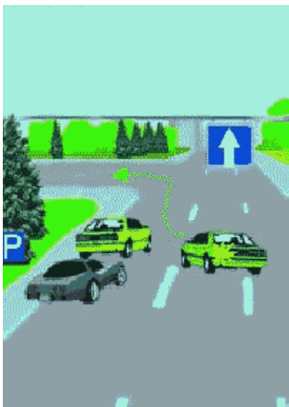
"Рисунок 9.1. Порядок выполнения поворотов: а - на дороге с односторонним движением при организованной стоянке на крайней левой полосе"
