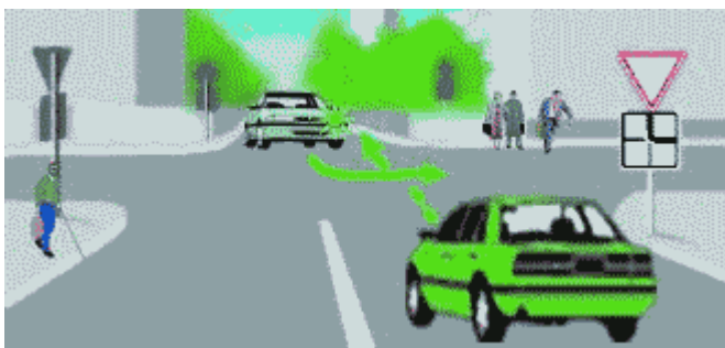
"Рисунок 25. Табличка 7.13 используется для указания направления главной дороги на перекрестке"
